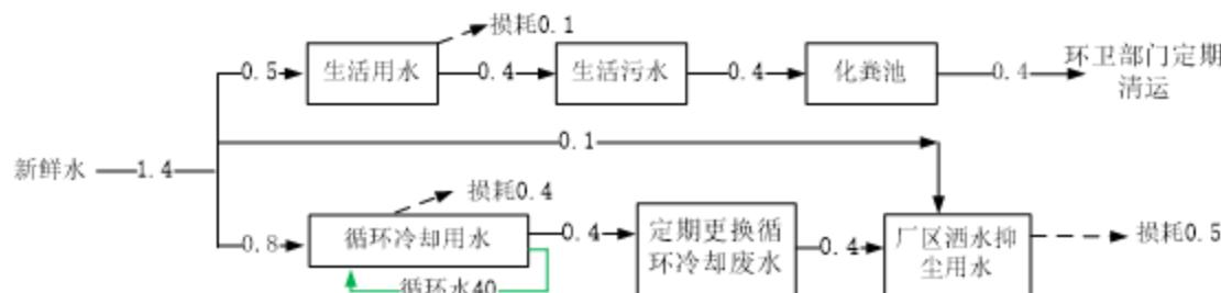
图 2-1 项目水平衡图 (单位:  $\text{m}^3/\text{d}$ )
