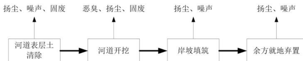
图 2-6 河道疏浚工程施工工艺流程图
