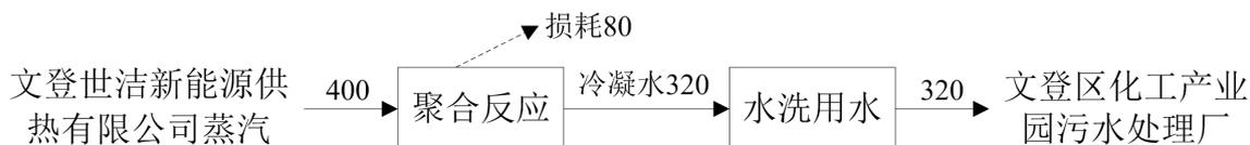
图 2.4-3 项目蒸汽平衡图 (t/a)
