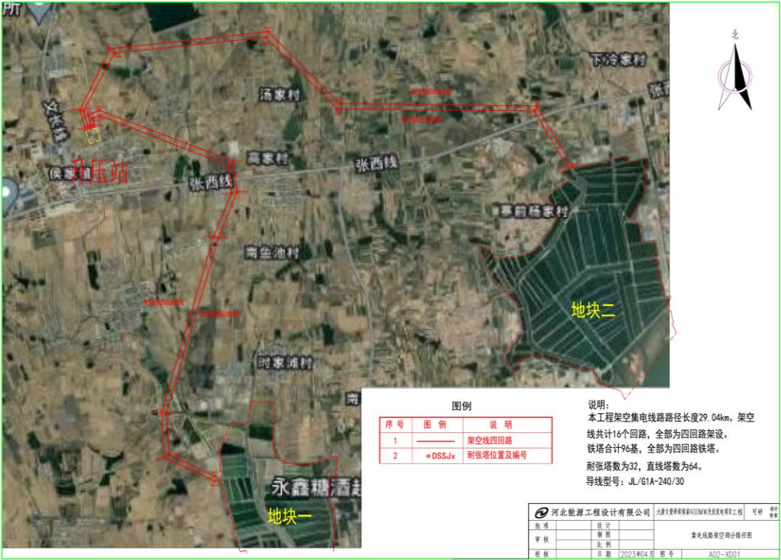
图 2.2-7 集电线路架空部分路径图
