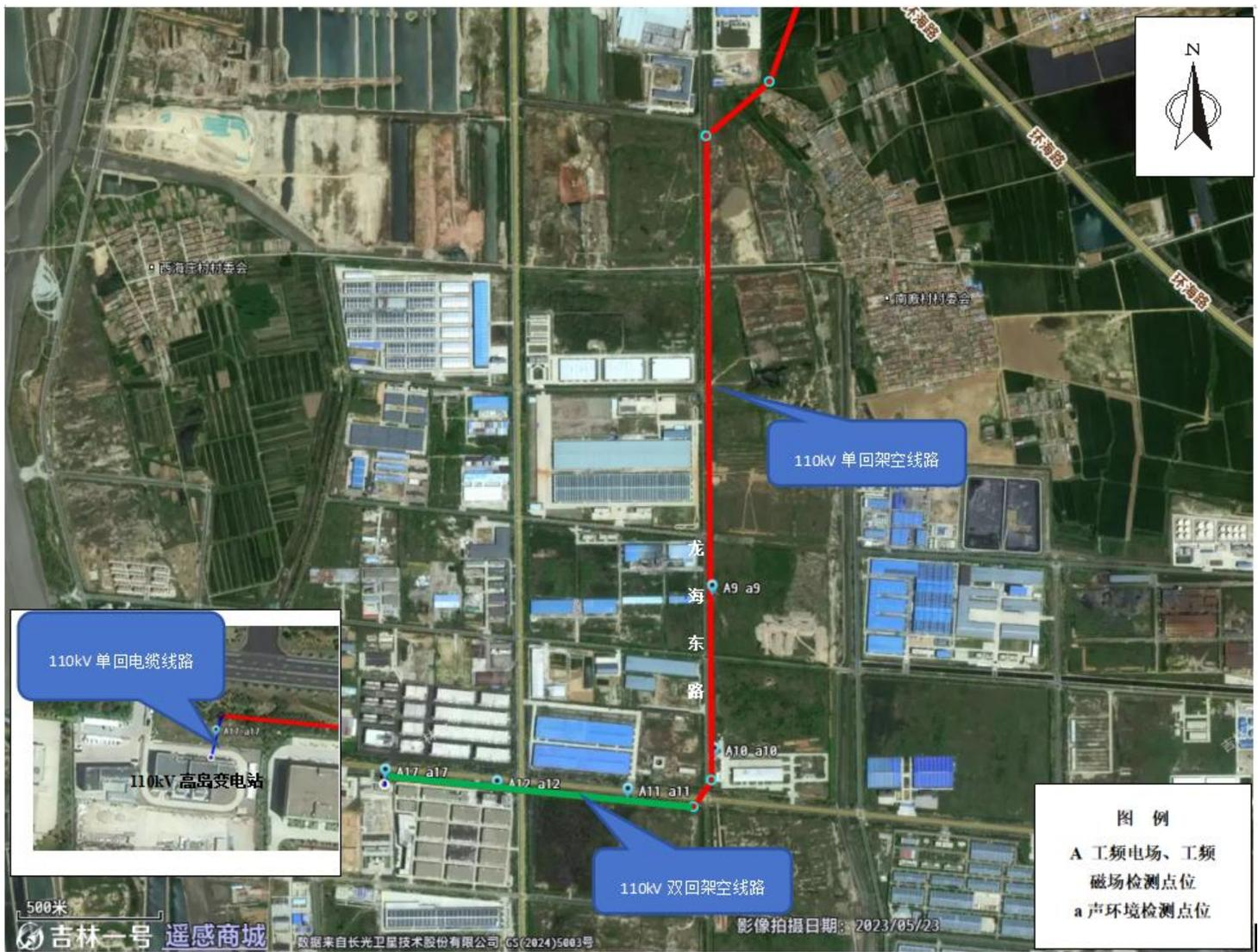
附图 5 (d) 拟建输电线路路径及检测布点示意图
