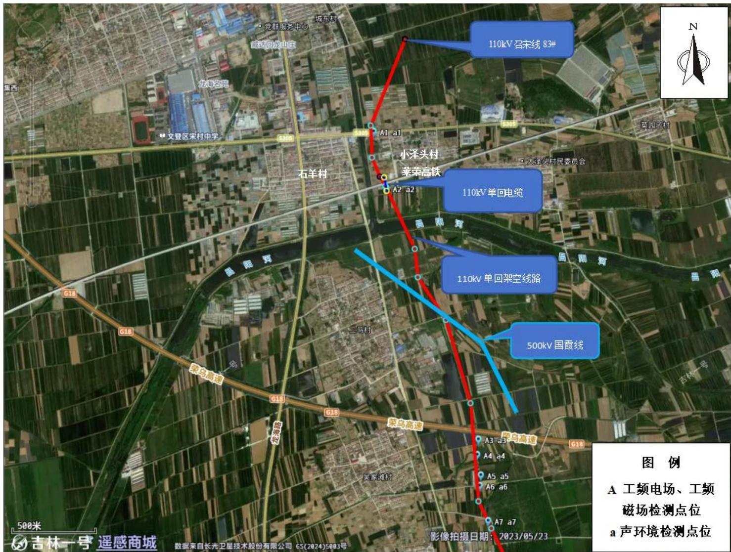
附图 5 (b) 拟建输电线路路径及检测布点示意图
