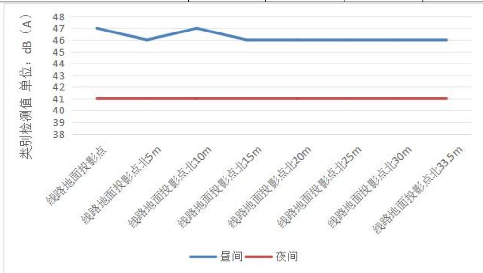
**图 4-2** 110kV 同塔双回架空线路昼、夜间噪声趋势图
