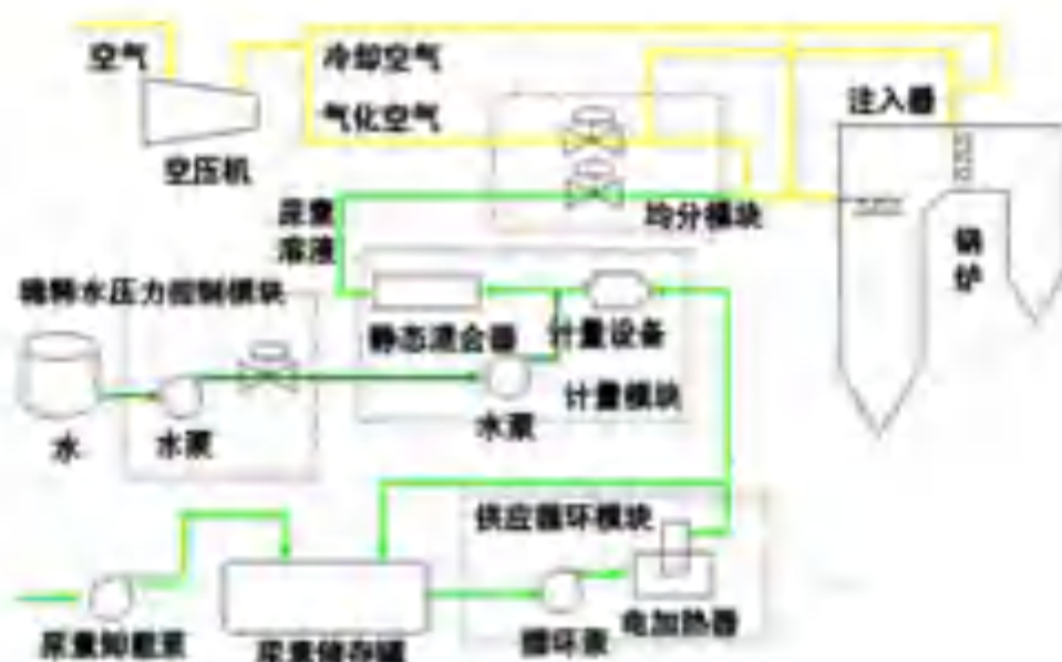
图2.3-6 脱硝系统工艺流程图
